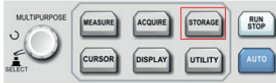
Рис. 9-1. Клавиша функции STORAGE
