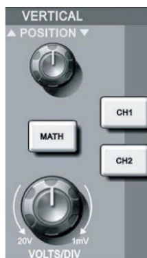
Рисунок 1-6 — Зона вертикального управления на панели
