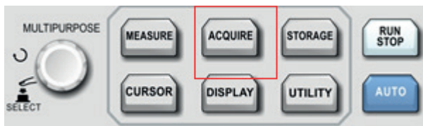
Рис. 5-1. Клавиша функции системы Acquire
