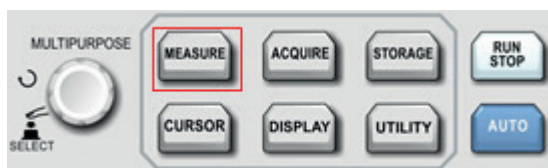
Рис. 7-1. Клавиша функции автоматических измерений
