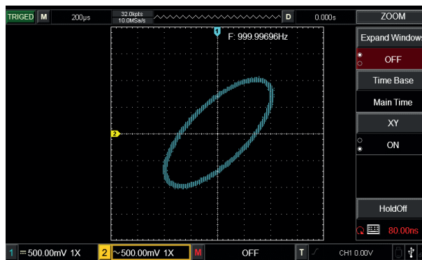
Рисунок 3-5. Отображение формы сигнала в режиме XY
